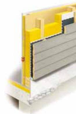
Wandaufbau der Holzskelettbauweise.
